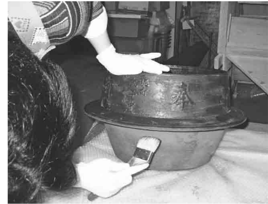
鋳鉄製の羽釜に防錆のために椿油を塗る。ブラシでクリーニングした後に、椿油を刷毛で塗っている
