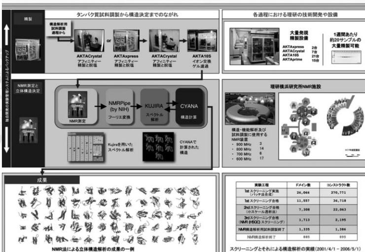
図4 NMR解析におけるタンパク質試料調製と構造解析の流れ(理化学研究所の例(2))
