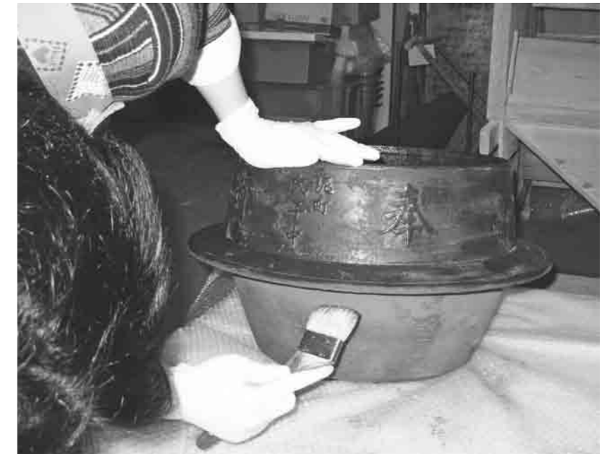
鋳鉄製の羽釜に防錆のために椿油を塗る。ブラシでクリーニングした後に、椿油を刷毛で塗っている
