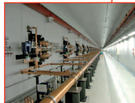
加速器棟の遮蔽トンネル内にて、Cバンド加速器が約300 mに渡って設置される。
