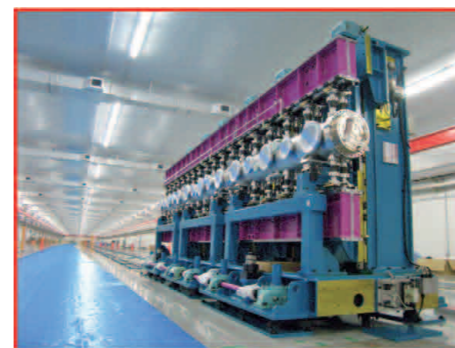
光源棟には、全長5 mのアンジュレータが約100 mに渡って設置される。
