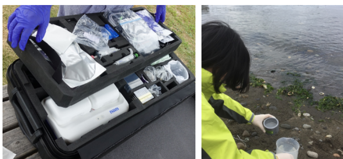
図。(左) チリに供与した最新バージョンでは、よりスリム化されている (W: 38cm, D: 24cm, H: 88.5 cm, 12 kg)。(右) チリの海岸にて海水サンプリングフィルターろ過中
