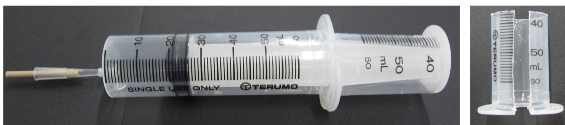
図3 吸引体積を約 20mL に増加させたセットアップ (50mL シリンジの後半部分に切り込みを入れて使用)
