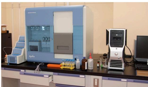
図3. 東京農業大学に設置されているイルミナ社製GAIIシーケンサー。右は制御用PC。サーバはDell社のPowerEdgeR900、CPUはXeon X7460 (2.66GHz)を6個、メモリは256GB、ハードディスク容量は48TB。
